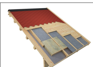
Structure isolation toiture*
